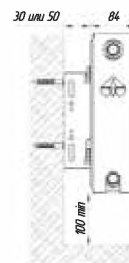
■ рисунок 2 - Крепление к стене радиатора ЛК
